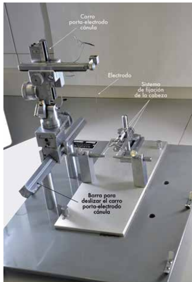
Figura 2. Aparato de estereotaxis para roedores. Obsérvese el sistema de fijación de la cabeza y la barra para deslizar el carro que porta los electrodos que se puede deslizar siguiendo el eje rostro caudal (coordenada z). El carro está preparado para deslizar el electrodo lateralmente (coordenada x) y bajarlo hasta alcanzar la estructura (eje dorso-ventral, coordenada y).
